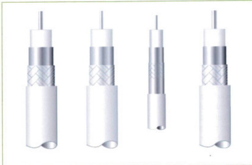
Abb. 6.10 – Schnittzeichnungen der Antennenkabel KOKA 220, KOKA 702, KOKA 7539 und KOKA 799, alle von Hirschmann. Das Beispiel soll zeigen, dass Antennenkabel meist sehr ähnlich aussehen. Die Unterschiede liegen im Detail. Und die erkennt man oft erst in den Datenblättern.
